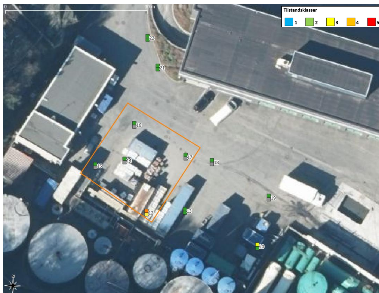
Figur 13. Tilstandsklassifiserte prøver (12-22) etter TA-2553/2009 i undersøkelsesområdet. Høyeste påviste tilstandsklasse er vist. Oransje firkant symboliserer plassering av tiltaket 'etablering av tett dekke'. Øverste kvadrat på de nummererte punktene symboliserer toppjord (0 – 1 m) og nederste kvadrat symboliserer dypere jordlag (1 – 2 m). Det dypere liggende jordlaget ved punkt 14, 15, 16, 17, 18, 19 (grå) utgikk på grunn av boring ned til berg/fjell. Punkt 12 ble påvist med konsentrasjon av arsen og sink tilsvarende TK4 og bly og kadmium tilsvarende TK3 i øvre jordlag. I dypere jordlag ved punkt 12 ble arsen og kobber påvist tilsvarende TK3. I det øvre jordlaget ved punkt 20 ble det påvist sink tilsvarende TK3. Konsentrasjoner i øvrige punkter og jordlag tilsvarte TK2.
