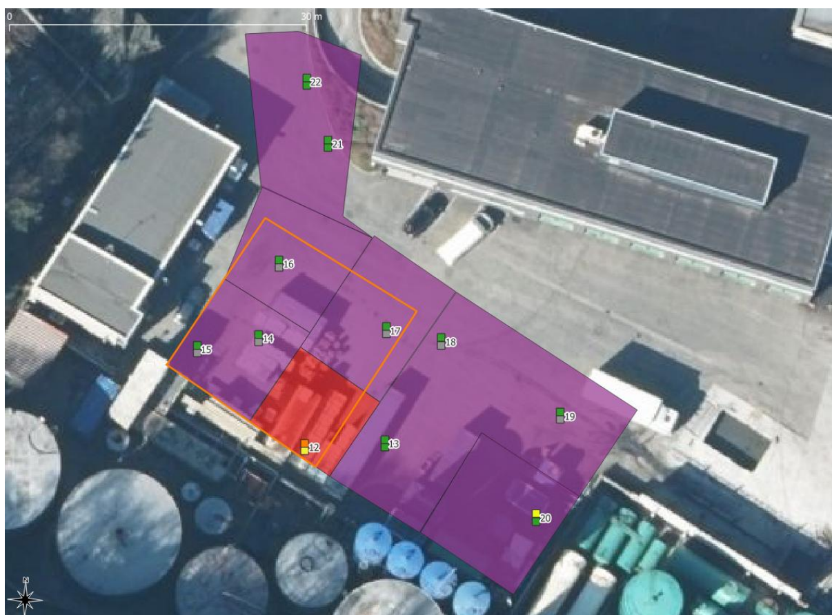
Figur 14. Massehåndtering på arealet som er kartlagt i forbindelse med tilstandsrapport for industriområdet samt avgrenset areal for tiltenkt tett dekke/betongplate (oransje firkant). Fargekoding henviser til tabell 5.
